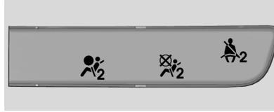
عند بدء تشغيل المركبة، يضيء مؤشر حالة الوسادة الهوائية للراكب الرمز التي تشير إلى التشغيل وإيقاف التشغيل، وذلك لعدة ثوانٍ كعملية فحص للنظام. ثم بعد عدة ثوانٍ، سيُفهم مؤشر الحالة بإضاءة رمز التشغيل أو رمز إيقاف التشغيل لإعلامك بحالة الوسادة الهوائية الأمامية للراكب الأمامي الجالس على الطرف.
