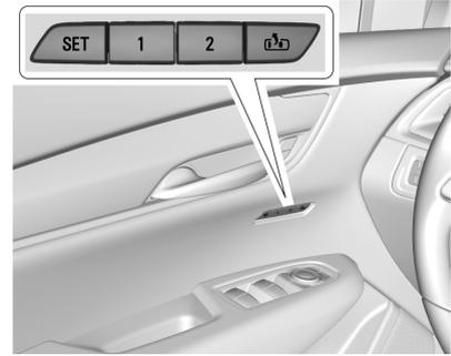
إذا كانت المركبة مجهزة بها، تتبع ذاكرة المقاعد لاثنين من السائقين بحفظ واستدعاء مواضع المقعد المختلفة الخاصة بهما لقيادة المركبة وموضع خروج مشترك للخروج من المركبة. ويمكن أيضاً حفظ مزايا مواضع أخرى، مثل المرايا الكهربائية وعجلة القيادة الكهربائية، إذا توفرت هذه الميزات. ترتبط ذاكرة المواضع بجهاز الإرسال RKE 1 أو RKE 2 لاستعادة الذاكرة تلقائياً.
