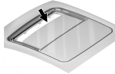
قد تتجمع الأتربة والنفائات على سداة فتحة السقف أو في مسارها. ويمكن أن يسبب ذلك مشكلة عند تشغيل فتحة السقف أو قد يسبب ضجيجًا. كما يمكن أيضًا أن يسد نظام تصريف المياه. افتح فتحة السقف بشكل دوري وقم بإزالة أي عوائق أو نفائات متبقية. امسح سداة فتحة السقف ومنطقة
