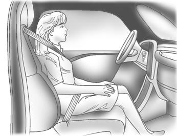
إذا كان هناك شخص بحجم بالغ يجلس في مقعد الراكب الأمامي الطرقي، ولكن كان مؤشر إيقاف التشغيل مضيئاً، فيمكن أن يكون ذلك بسبب عدم جلوس هذا الشخص في المقعد بشكل صحيح أو بسبب تعشيق ميزة قفل نظام أمان الأطفال. استخدم الخطوات التالية للسماح للنظام بالكشف عن هذا الشخص، ولتنشيط الوسادة الهوائية الأمامية للراكب الأمامي الطرقي:
