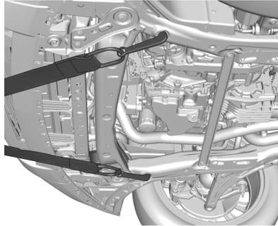
السيارة مزودة بنقاط تثبيت محددة يلزم استخدامها بواسطة موفر خدمة السحب. يمكن استخدام هذه الفتحات لسحب السيارة من طريق مسطح إلى ظهر ناقل السيارات ذات السطح المستوي.
