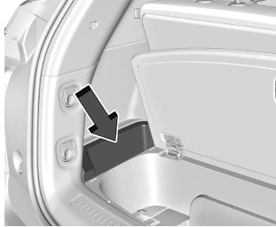
توجد مجموعة منصهرات المقصورة الخلفية في منطقة الحمولة بجانب السائق بالمركبة خلف لوحة الكسوة السفلية. للوصول إلى المنصهرات الكهربائية في المركز الكهربائي الخلفي، قم بإزالة حاوية الحمولة المركزية ثم حاوية الجانب الصغيرة. راجع التخزين الخلفي ٨٤. ارجع إلى الوكيل إذا لزمتم مساعدة إضافية.
